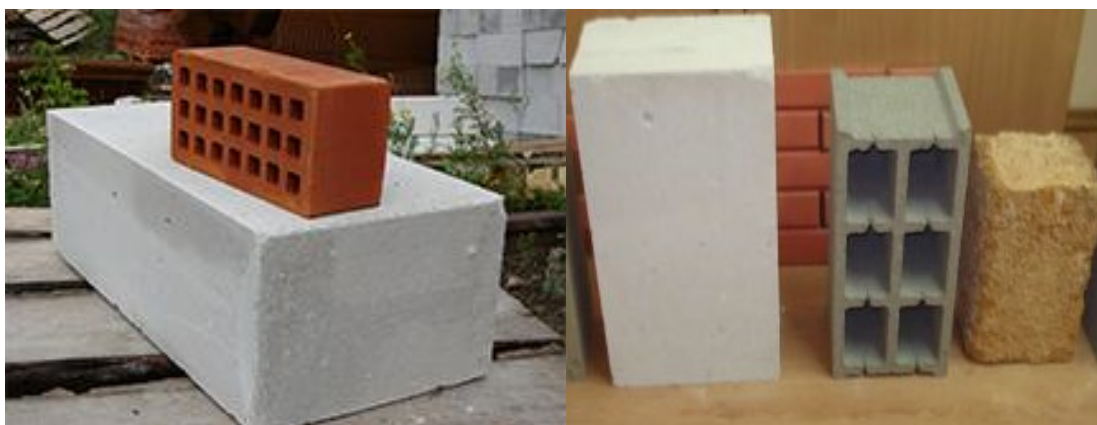
Рисунок 10. Сравнение габаритов кирпича, блока из газобетона и блока из ракушечника.
