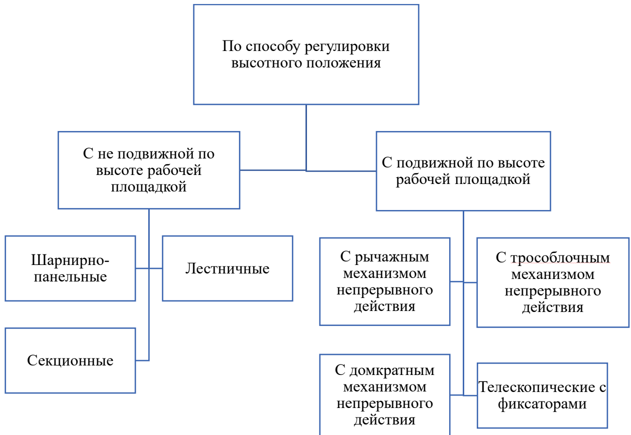
Рисунок 37. Классификация подмостей по способу регулировки высотного положения
