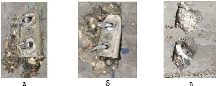
Рисунок 3 – Механизмы разрушения уголковых упоров в перекрытиях по съемной опалубке: а – срез дюбелей; б – вырыв дюбелей; в – разрыв упора
