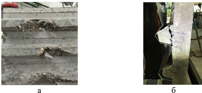
Рисунок 4 – Механизмы разрушения уголковых упоров в перекрытиях по несъемной опалубке из профилированного настила: а – продавливание бетонного ребра; б – срез бетонного ребра
