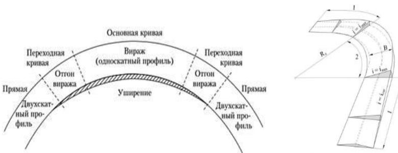
Рисунок 3 – Схема виража на дороге с двухскатной проезжей частью:
