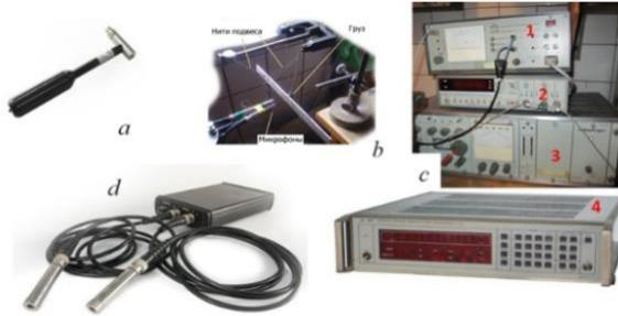
Рисунок 1. Акустическая часть оптико-акустического стенда: а - ударный молоток, б - груз (шарик) на подвесах, с - аппаратный блок: 1 - усилитель LV 103, 2 - частотомер ЧЗ-63, 3 - вибровозбудитель Рототрон 11075, 4 – генератор звука ГЗ-122, d - микрофоны, соединенные со спектроанализатором А19-У2
