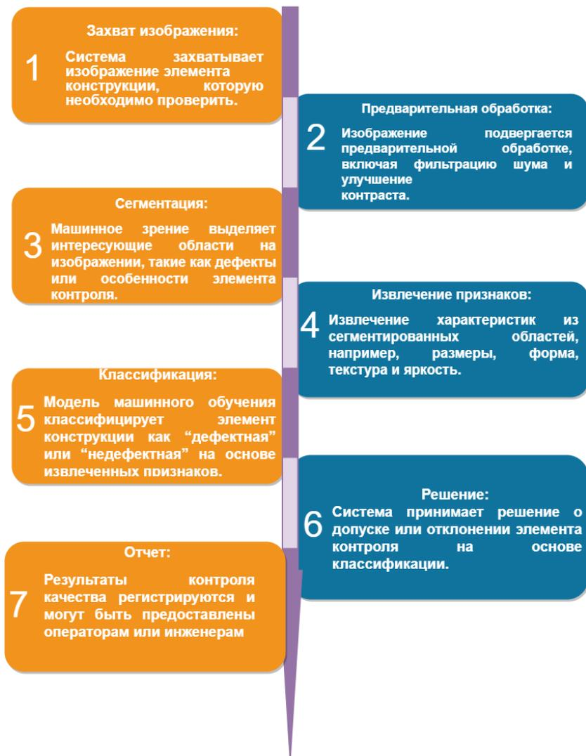
Рисунок 1 - Блок-схема для обеспечения контроля качества при аддитивном строительном производстве
