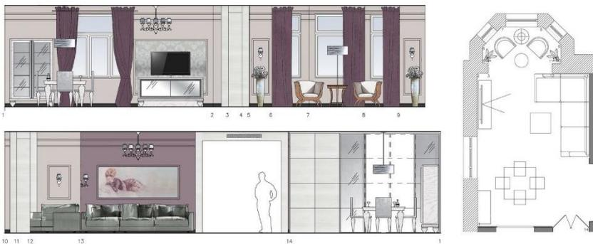
Рисунок 1 - Развертка гостиной вдоль стен с использованием сложного разреза
