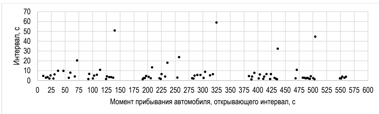
Рис.4 Зависимость «момент прибытия автомобиля, открывающего интервал – длительность открываемого интервала» (Перекресток ул. Батарейная – ул. Чайковского, Лобня 19.11.2022).
