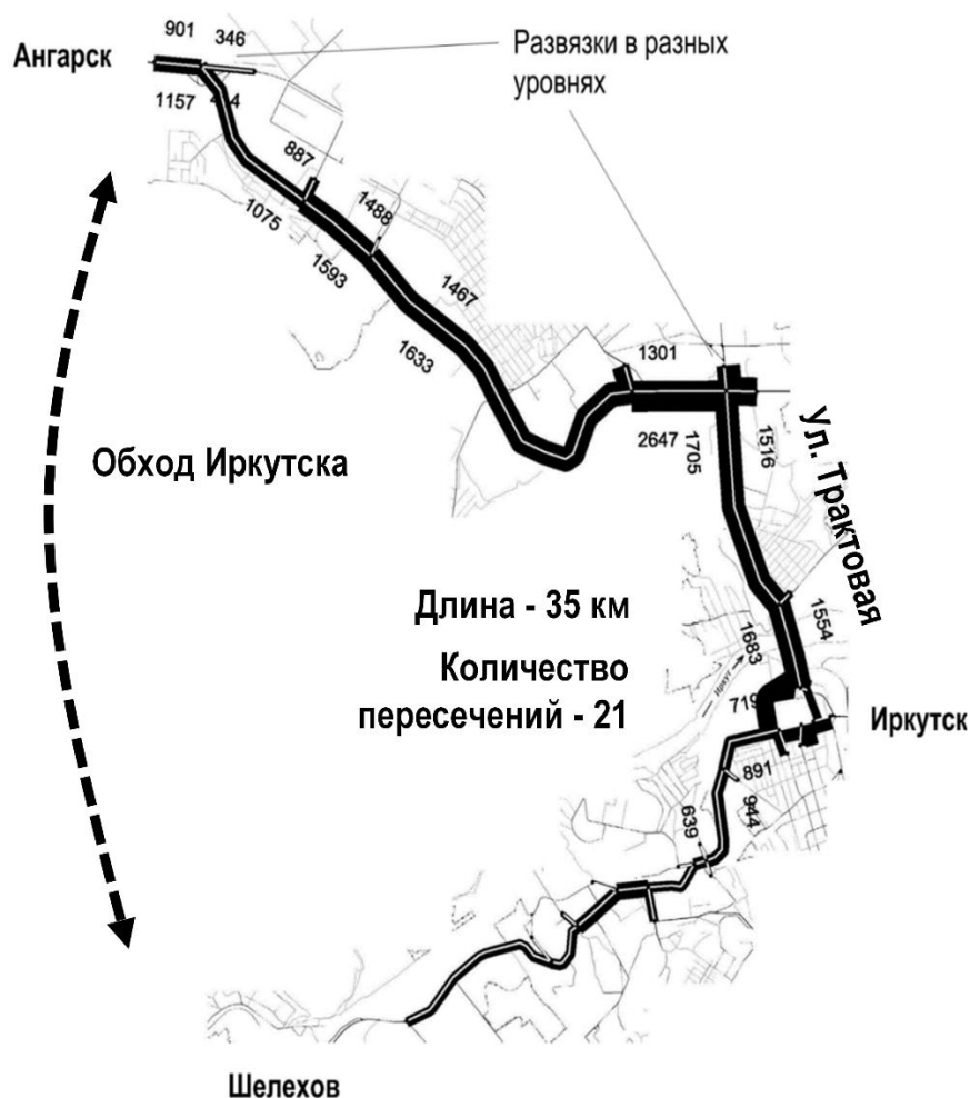
Рис. 5. Применение метода восстановления матрицы корреспонденций по замерам интенсивностей движения (авт./ч) вдоль транспортного коридора для принятия решений по планированию нового транспортного коридора в границах Иркутской агломерации в обход г. Иркутска (2009 г.) [11, 12]
