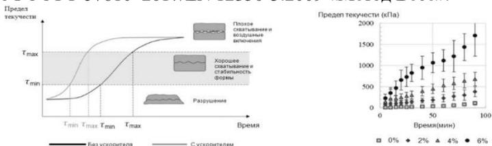
Рис. 13 Зависимости сроков схватывания от количества ускорителя
