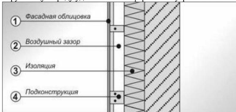
Рис. 2. Расположение воздушного зазора
