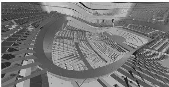
Рис. 1. Параметрическое моделирование зала «Зарядье» в Grasshopper
