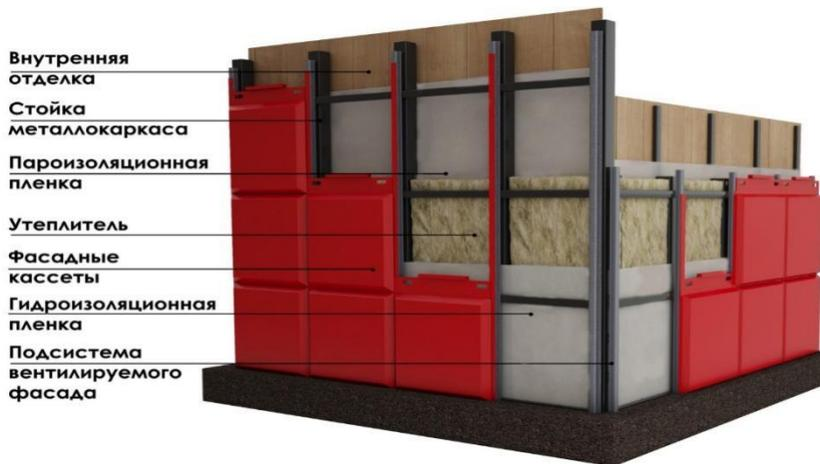
Рис. 1. – Схема устройства навесного фасада.
