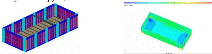
Рис.2. Модель типового модуля, построенная в ПК ЛИРА Софт и мозаика усилий
