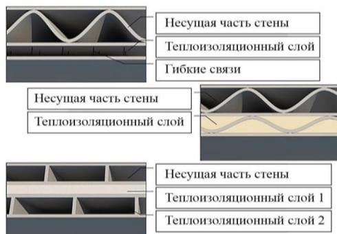
Рис. 3 Типы конструктивных решений стен, предложенных ArisCor
