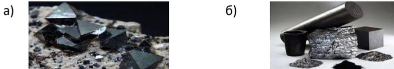
Рис.1. Добавки для токопроводящего бетона: а) магнетит, б) графит
