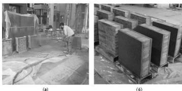
Рис. 2. Процесс подготовки серий образцов: а) процесс напыления слоя торкрет-бетона на образцы стен, б) серии готовых образцов стен [2]
