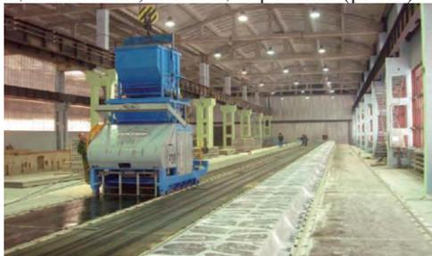
Рис.4 Безопалубочное формование
