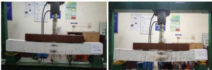
Рисунок 9 Характер трещин ж.б. балки при испытании на 28 сутки (слева-без добавления золы-уноса; справа – с добавлением золы-уноса 40%)
