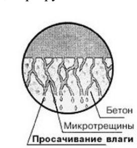
Рис 1. Микротрещины в необработанном бетоне
