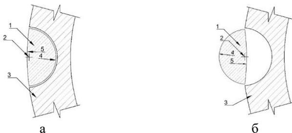
Рис. 1. Устройство интерцептора, а – “открытого”, б – “закрытого”: 1 – интерцептор; 2 – ось вращения; 3 – тело трубы; 4 – поверхность “открытого” интерцептора; 5 – поверхность “закрытого” интерцептора
