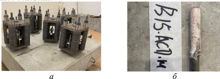
Рис. 1. Испытание анкеров: а) установка клеевых анкеров на длительные нагрузки; б) характер разрушения
