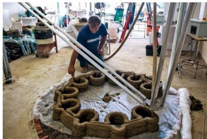
Рис.6 Трёхосевой (дельтовидный) принтер
