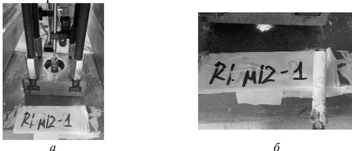
Рис. 1. Проведение испытания: а) образец до испытания, б) разрушение по контакту клеевого состава и бетона основания
