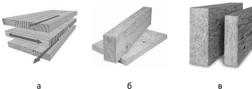
Рис.2 Схематичное изображение деревянных конструкций; а - CLT – панель, б - LVL – панель, в - LSL – панель
