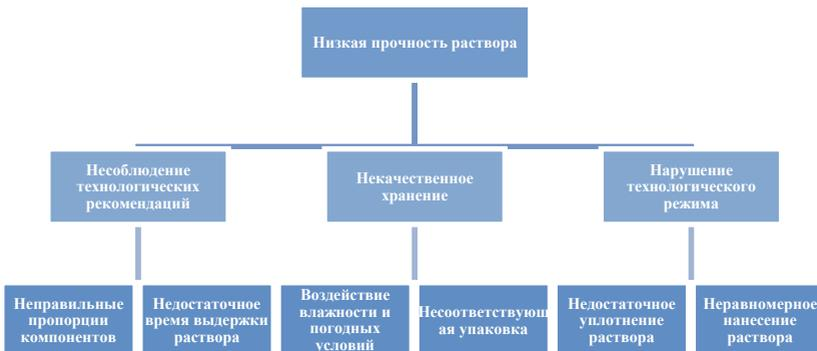
Рис. 1. Дерево отказов для дефекта низкой прочности раствора
