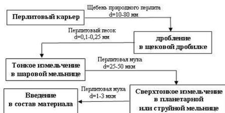
Рис. 1. Технологическая схема получения тонкодисперсного перлита [5]
