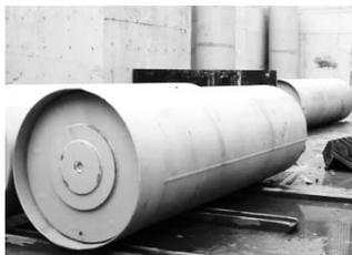
Рис. 2. Кинематическая опора
