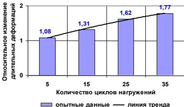
Рис.4. Относительное изменение длительных деформаций в нормальных условиях к длительным деформациям при ЦЗО
