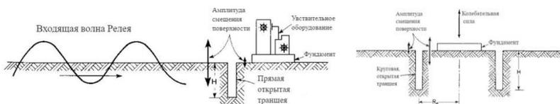
Рис. 1, 2. Схемы устройства круговых траншей
