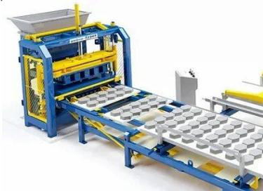
Рис.1 Формование тротуарной плитки вибропрессованием
